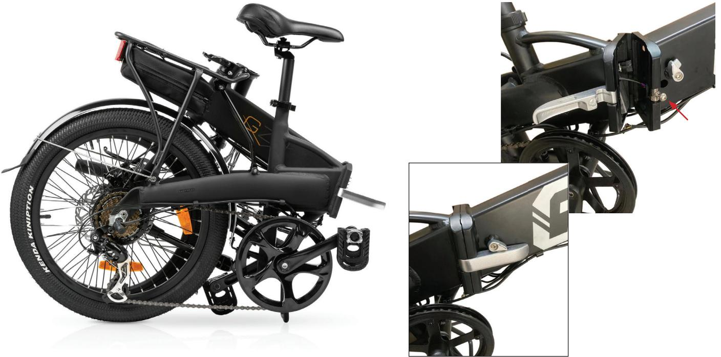
2. Lås brytledens snabblås ordentligt, vrid snabblåsets säkring på plats och säkerställ att ramen är rak. Du kan justera låsets styvhet med skruven som på bilden är markerad med en röd pil.
