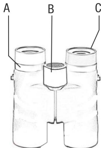
necesario que se utilice un pincelillo sin fibras de acrílico. Para remover la suciedad y las huellas digitales, hay que, con un paño liviano de algodón, limpiar las lentes con movimientos circulares. Tanto el uso de un paño áspero como una limpieza demasiado asidua pueden rayar la superficie de las lentes. Para una limpieza en profundidad se puede usar un líquido específico para la limpieza de lentes fotográficas que siempre deberá aplicarse sobre el paño y nunca directamente sobre la lente.
