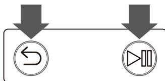
Kun käynnistät television ensimmäistä kertaa, Samsung Smart Remote muodostaa automaattisesti parikytkennän television kanssa. Jos Samsung Smart Remote ei muodosta parikytkentää television kanssa automaattisesti, osoita sillä televisiossa olevaan kaukosäätimen anturiin ja paina vasemmalla olevassa kuvassa näytettyjä - ja -painikkeita samanaikaisesti vähintään 3 sekuntia.
