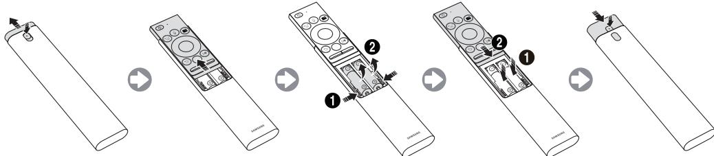
1. Paina -painiketta Samsung Smart Remote -laitteen takasivun päässä. Runko irtoaa hieman rungon kotelosta.
