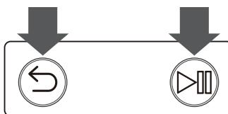
När du slår på tv:n för första gången paras Samsung Smart Remote ihop med tv:n automatiskt. Om Samsung Smart Remote inte paras ihop med tv:n automatiskt ska du rikta den mot fjärrkontrollsensorn på tv:n och sedan trycka på och hålla ned knapparna som är märkta med och i bilden till vänster samtidigt i 3 sekunder eller mer.
