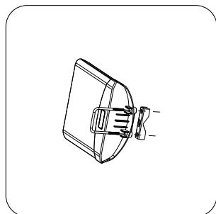
3. Fäst antennen till masten med vindmuttrarna.
