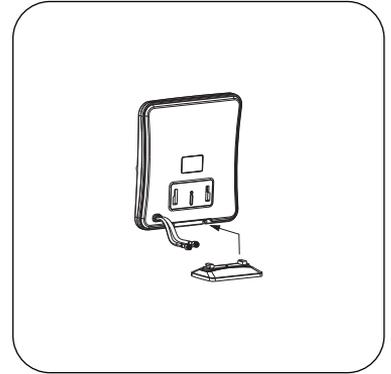
2. Kytke kaapelin SMA-liittimet reitittimen SMA-liitäntöihin.
