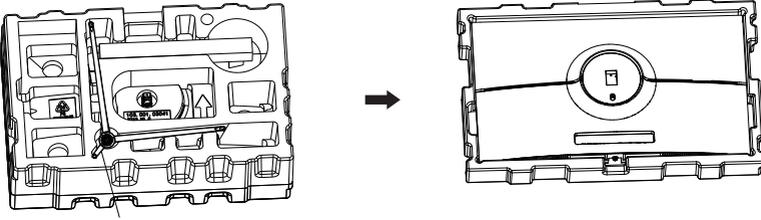
2. Poista ylempi pehmuste ja suojamuovit näytön ympäriltä. Asenna jalusta tukivarteen ja kiristä jalustan pohjassa oleva ruuvi. Älä ylikiristä ruuvia. Paina lopuksi jalustakiinnikkeen vieressä oleva vipu ylöspäin ja aseta tukivarsi ja jalusta kiinni näytön takana olevaan aukkoon. Vipu napsahtaa takaisin paikalleen.
