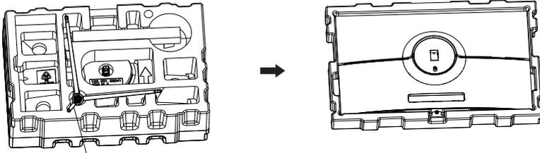
2. Ta bort den övre frigolitplattan och skyddsplast. Montera foten till stödarmen och dra åt skruven i fotens botten. Överspänn inte skruven. För spaken vid fotanslutningen uppåt och sätt stödarmen och foten till hålet bakom skärmen. Spaken klickar på plats igen.
