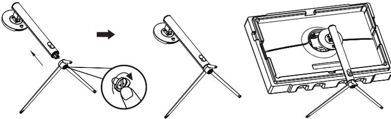
3. Käännä näyttö pystyyn jalustan varaan. Varmista, että osat ovat tukevasti kiinnitettyinä toisiinsa. **Huom!** Älä purista näyttöä sormilla laitetta käsitellessäsi.
